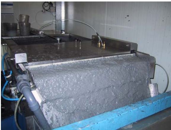
Collecteurs de surface mis en oeuvre jusque là. Boues de peinture caractérisées par une humidité résiduelle importante
