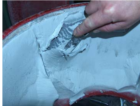
separierter Glasschlamm aus STA-Zentrifuge – stichfest und spatentrocken
