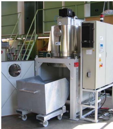
automatisch austragender Separator Baureihe A-25
