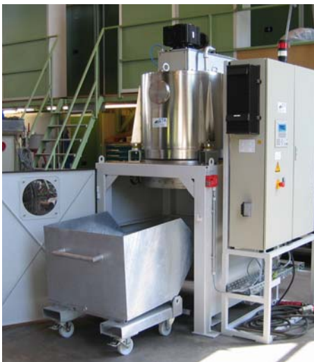
Séparateur à évacuation automatique (gamme A-25)
