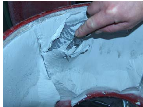
separierter Glasschlamm aus STA-Zentrifuge – stichfest und spatentrocken
