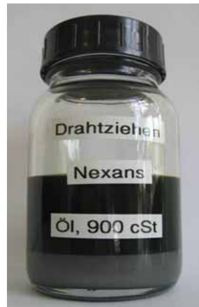
Bild 1: Probe des verunreinigten Drahtziehöls nach 9 Monaten. Erst nach langer Zeit setzen sich die Aluminiumpartikel ab -> im Zentrifugal-Separator wird dieser Vorgang 2.000-fach beschleunigt
